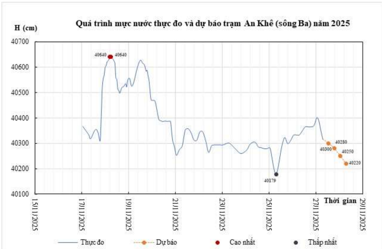
Hình 2: Quá trình mực nước thực đo và dự báo trạm thủy văn An Khê
