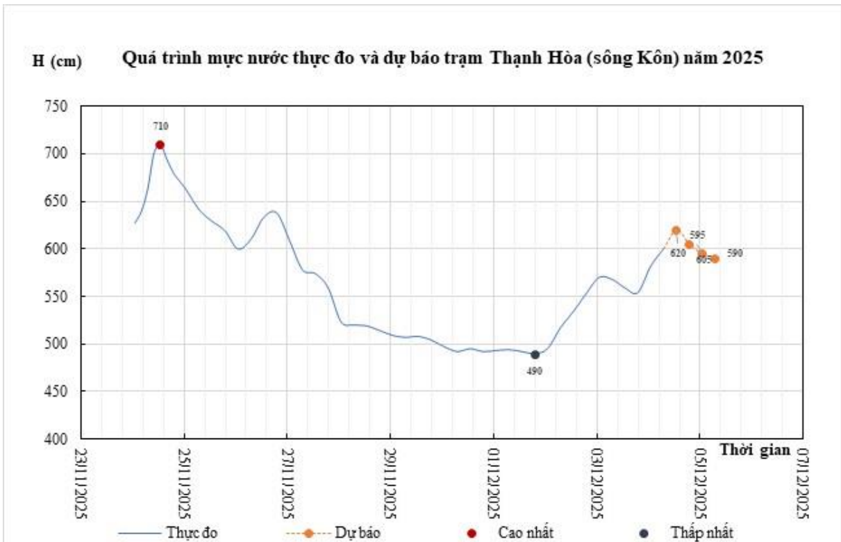
Hình 8: Quá trình mực nước thực đo và dự báo trạm thủy văn Thạnh Hòa
