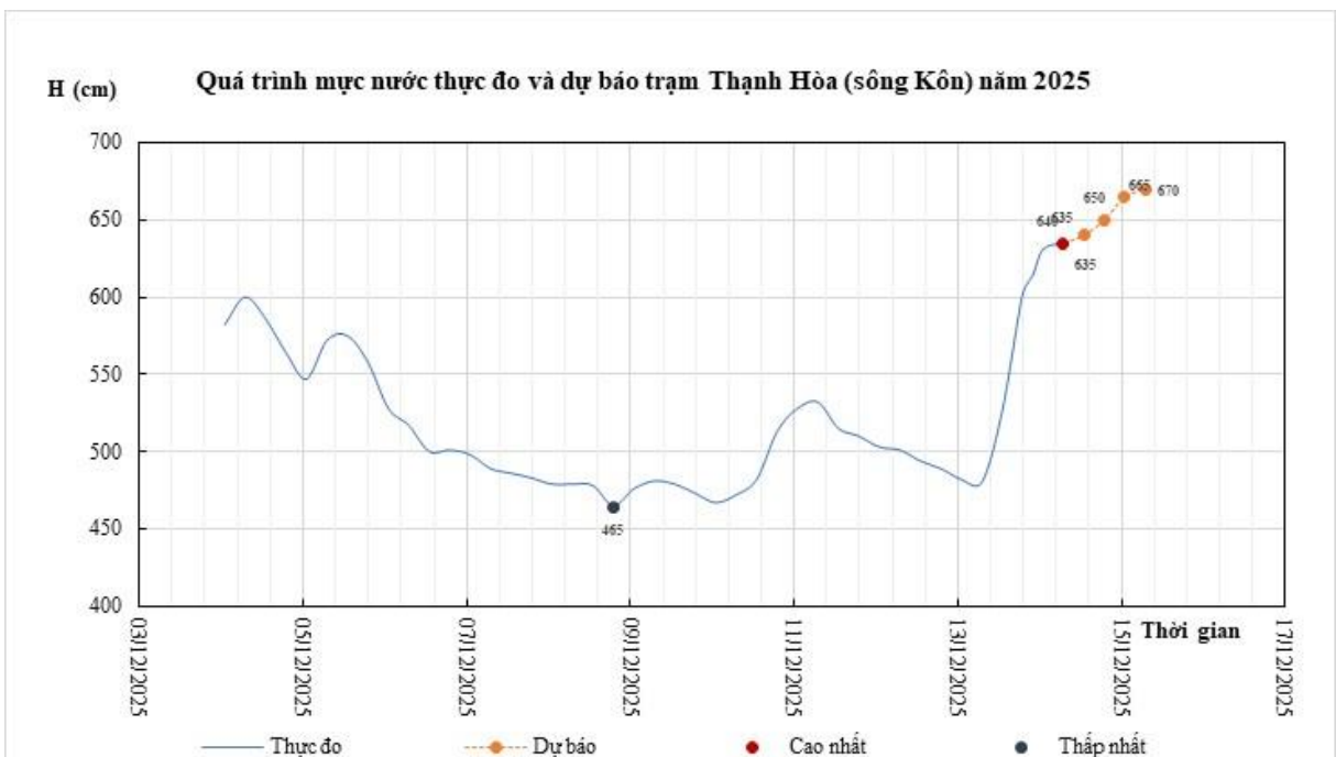
Hình 8: Quá trình mực nước thực đo và dự báo trạm thủy văn Thạnh Hòa
